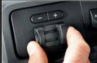
**FACTORY-INTEGRATED TRAILER BRAKE CONTROLLER OPTION**
